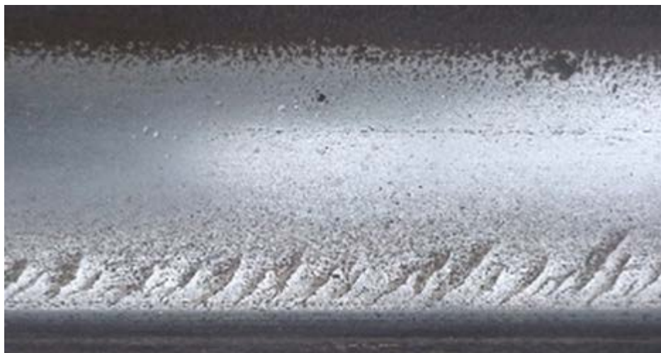
Foto 1 Head Checks met een scheurlengte aan het oppervlak van circa 20 mm
